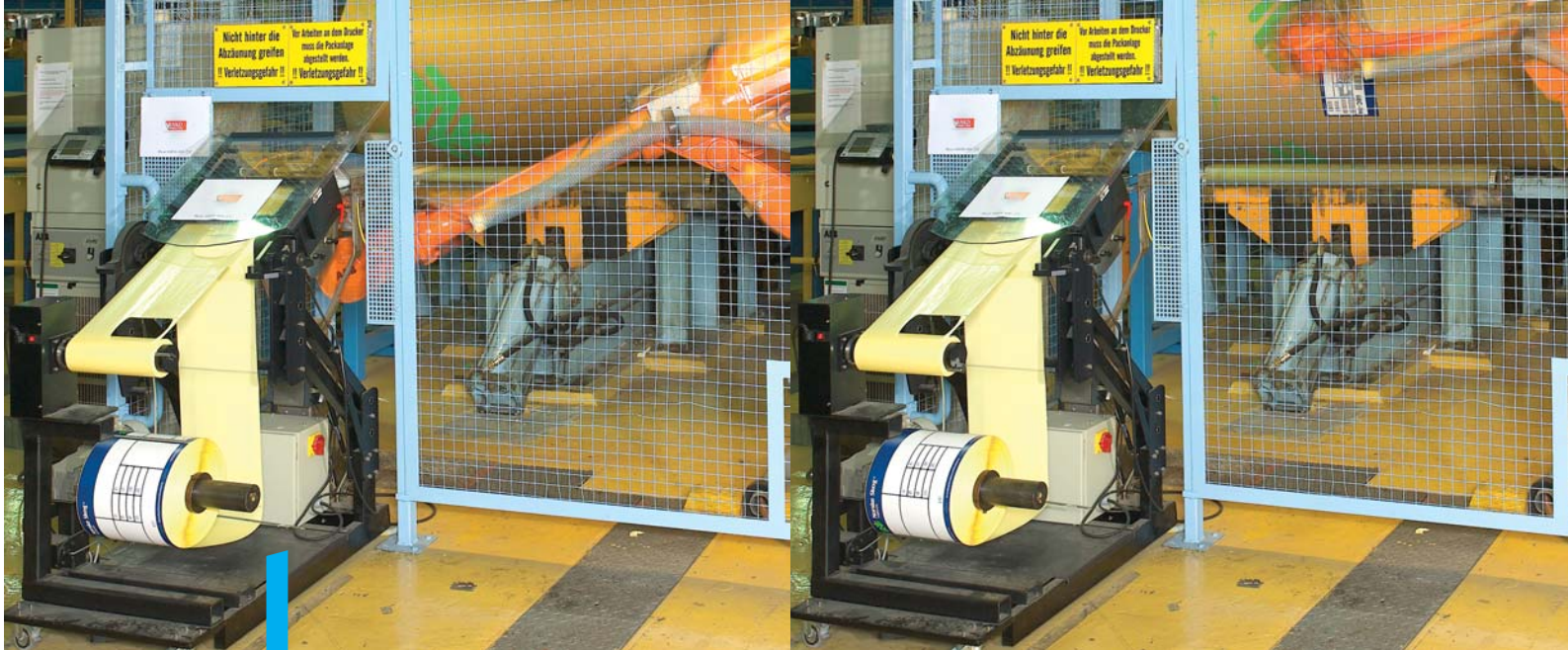
In Einklang mit dem Roboter: Etikettieren in A3 mit dem MP 300 von Imaje
